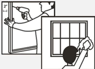
3. Taladre a 2 pulgadas de profundidad con broca 1/4" sobre los puntos marcados. Posteriormente coloque los taquetes de plástico. Limpie el espacio de instalación y coloque nuevamente la ventana con el protector incluido haciendo coincidir las perforaciones del protector con las de la ventana.
