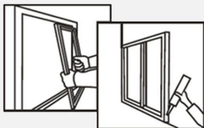
4. Use las pijas #10x2" (se recomienda usar pijas de seguridad tipo unidireccional) y el desarmador para fijar la ventana, atornille de manera cruzada, vuelva a colocar el mosquitero y el panel que desliza (de la misma forma que lo retiró). Para sellar aplique silicona en el perímetro interior y exterior de la ventana (donde se une el marco y el muro), así como en las ranuras inferiores cercanas a los drenes.
