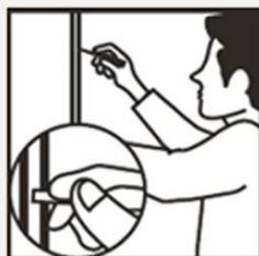
2. Marque con un lápiz en el muro los cuatro orificios circulares de la ventana y retirela.
