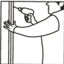
2. Sin retirar la puerta del vano, abra la hoja y realice tres perforaciones con broca para metal  $\frac{1}{4}$ " en el marco vertical del lado derecho e izquierdo (a 5 pulgadas de la parte superior, 5 pulgadas de la parte inferior y al centro) y márquelas en el muro con un lápiz.
