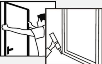
4. Coloque nuevamente la puerta en el vano y fíjelo con las pijas #10x2" y el esarmador, atornille de manera cruzada, asegúrese que la puerta opere correctamente, es decir, que abra y cierre sin problema. Para sellar aplique silicón en el perímetro interior y exterior del marco de la puerta.
