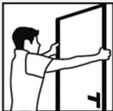
1. Coloque provisionalmente la puerta en el vano asegurándose de que esté nivelada verticalmente, de ser necesario calce con cuñas de madera para verificar la operación y cierre.
