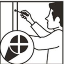
3. Retire la puerta y realice las perforaciones en el muro a 2 pulgadas de profundidad con broca para concreto  $\frac{1}{4}$ ". Posteriormente coloque los taquetes de plástico.
