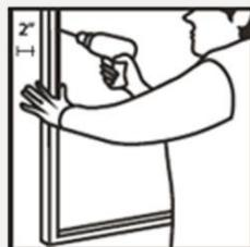
3. Taladre a 2 pulgadas de profundidad con broca  $\frac{1}{4}$ " sobre los puntos marcados. Posteriormente coloque los taquetes de plástico.
