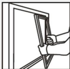
4. Limpie el espacio de instalación y coloque nuevamente la ventana. Use las pijas #10x2" y el desarmador para fijar la ventana, atornille de manera cruzada. Para sellar aplique silicón en el perímetro interior y exterior de la ventana (donde se une el marco y el muro), así como en las ranuras inferiores.
