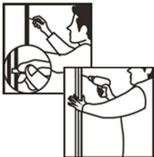
3. Realice tres perforaciones en los perfiles laterales con broca para metal de 1/4” en el marco vertical del lado derecho e izquierdo (a 5 pulgadas de la parte superior, 5 pulgadas de la parte inferior y al centro). Marque con un lápiz en el muro los seis orificios circulares de la puerta.
